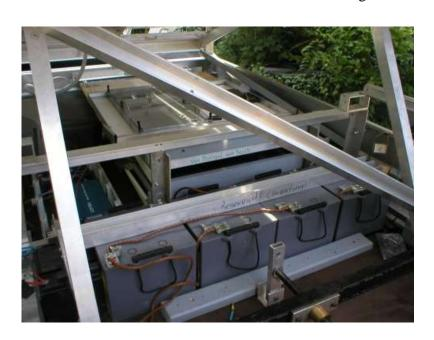
Über der Rad-Achse befinden sich 4 Stück Blei-Gel-Akkumulatoren mit je 12V/130Ah, die als Zweiereinheiten in 24V/130Ah verschaltet wurden. Die Akku-Kapazität beträgt Brutto 5200 Wh.
