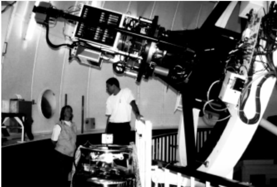
Abbildung 8: CCD-Kamera im Primärfokus des „Isaac-Newton-Teleskopes“ (2,49 m)
