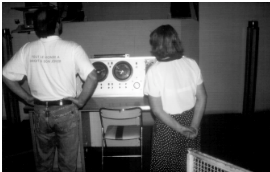
Abb. 3: Der Night-Assistent stellt in der Kuppel von Hand Rektaszension und Deklination ein.
