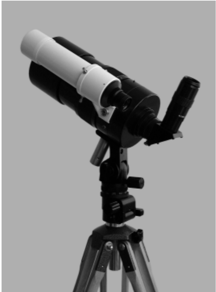
Bild 1: Die „Russentonne“ mit Sucher, Zenitprima und 40mm-Plössl-Okular auf azimutaler Montierung und Berlebach-Stativ
