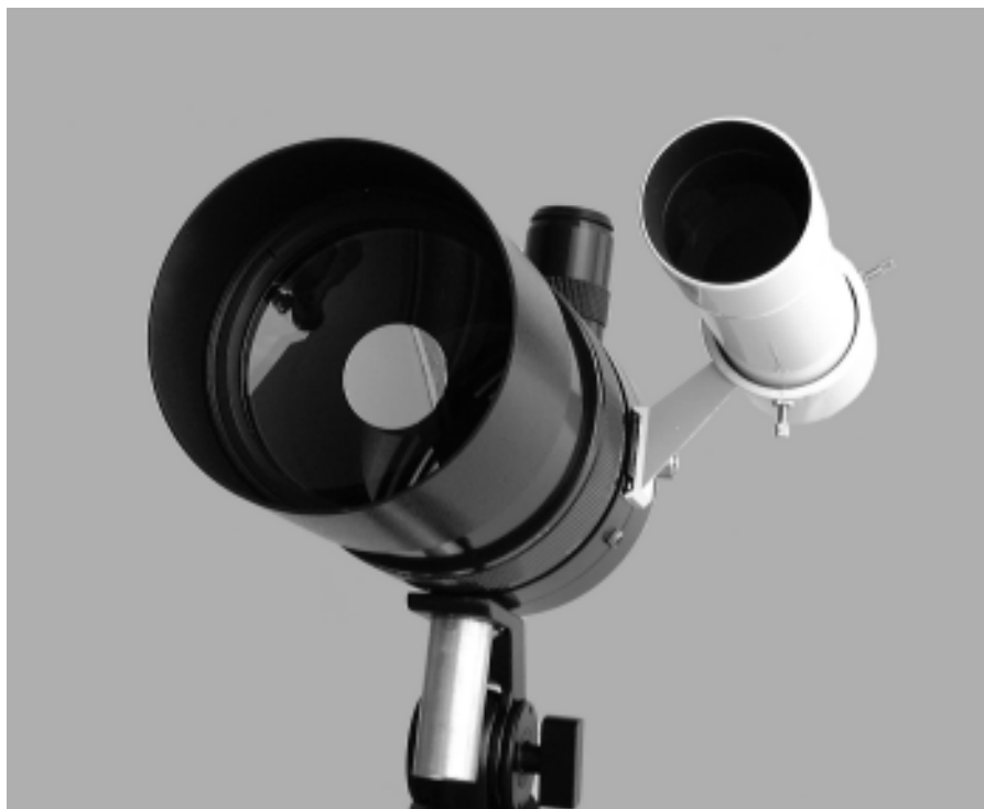
Bild 2: Blick von der Vorderseite des Tubus auf die Meniskus-Linse mit dem relativ großen Gegenspiegel
