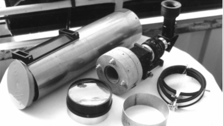
*Bild 1: Das Fernrohr und seine Teile: v.l.n.r. - der Tubus mit bereits aufgesetzter Telradsucherbasis und „Objektivdeckel“, dem Endverschluß eines 4"-Abwasserrohres, der komplette Okularauszug, das Objektiv und der Arretierring, sowie zwei Rohrschellen, die ursprünglich dafür gedacht waren, ein vierzölliges Abwasserrohr an einer Außenwand zu halten. Es ist kaum zu glauben, was ein Baumarkt für den bastelnden Sternfreund alles so hergibt. So...*
