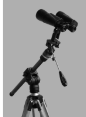
Bild 2: Bei Ferngläsern mit hoher Vergrößerung ist ein Fotostativ dringend anzuraten. Im Bild: der Carl Zeiss Jena Pentakarm 15x50 auf einer Fernglasmontierung mit einem Schwenkarm und Neigekopf.
