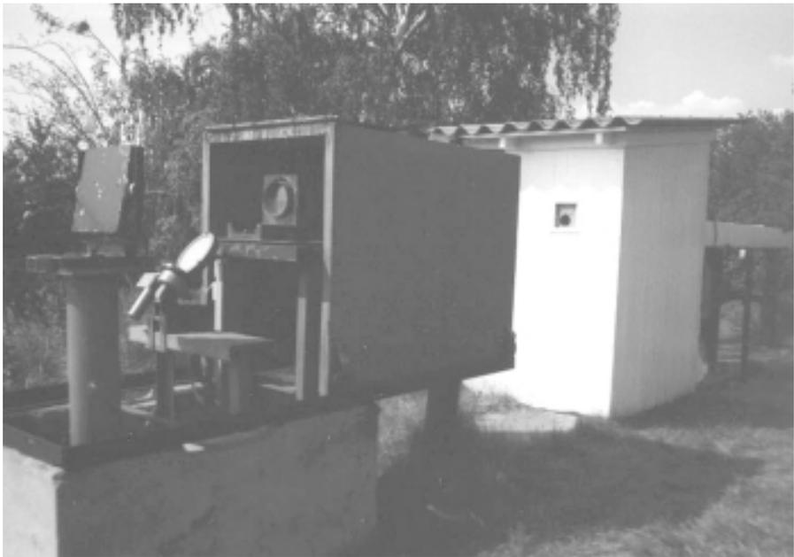
Abb. 1) Spektrograph und Coelostat mit einer Gesamtlänge von knapp 9 m
