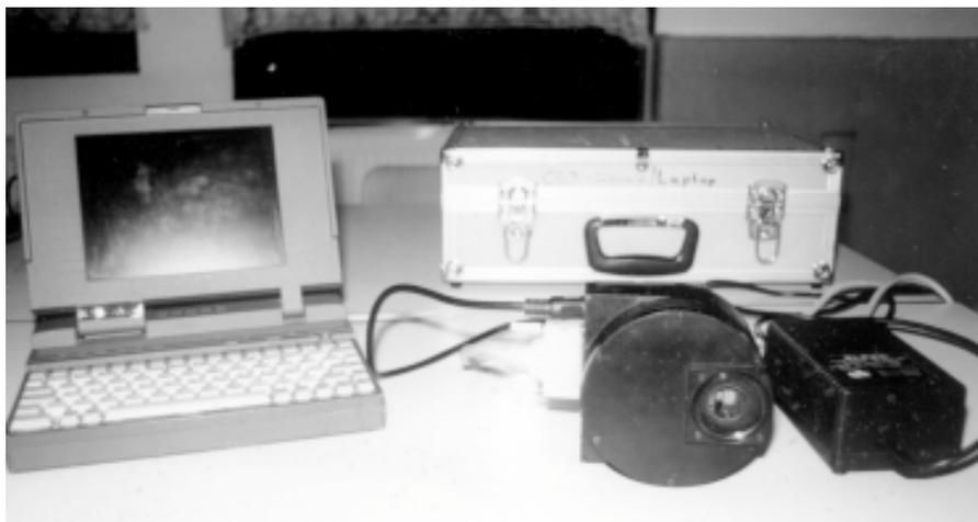
Abb.2) CCD-Kamera ST-7 von SBIG (USA) mit Netzteil, Laptop und Transportkoffer
