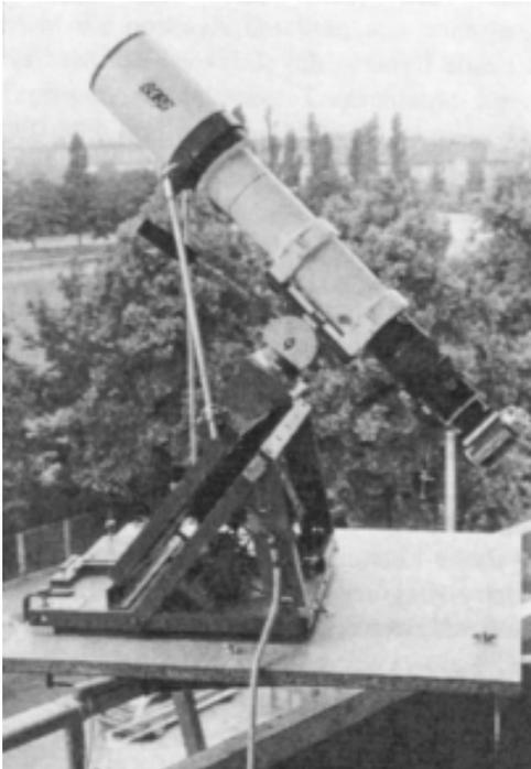
*Gerät auf der Südseite mit BORG ED100 Apo und angesetzter Barlowlinse (ohne Stützschiene), vorn Streben zur Stabilisierung*
